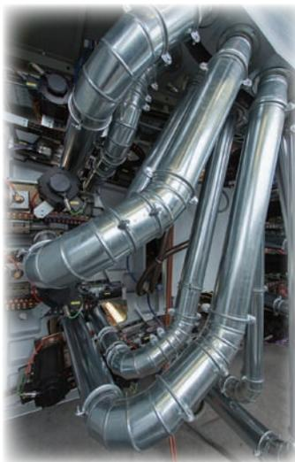
■ KBA-Flexotecnica 的新型乾燥烘道可以降低熱能消耗。
