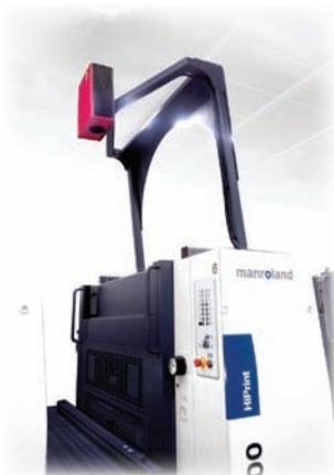
作人員快速地準備印刷和作業生產。ROLAND InlineInspector 2.0 聯線檢測裝置還能 100% 檢測每個印張，確保精確地檢測缺陷，而且操作方便。此外，配備的 InlineFoiler 聯線冷燙裝置還實現了印後加工和設計的可能性，■
