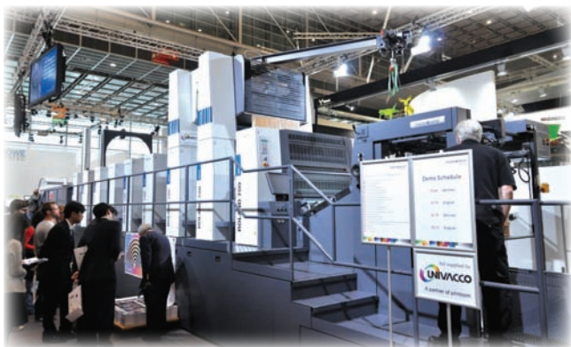
■ 中國印刷企業對設備技術的要求提高了不少，曼羅蘭配備有聯線上光裝置、UV 模組及 InLineFoiler 聯線冷燙裝置的六色 ROLAND 700 HiPrint 膠印機獲得他們的青睞。
