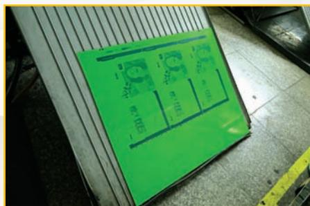
■ 無水印刷在製版和印刷的過程中，不會排放 VOC，並提升印刷品質，減少耗損。
