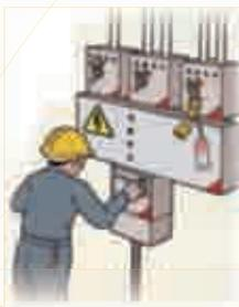
■ 在施工時，要關掉相應的開關擊或斷路器，或移除設備的電源線等以隔離電源，並應利用附於擊上的鎖或獨立的掛鎖，鎖上開關擊或擊盤以隔離電源，另鎖匙亦須妥為保管。
