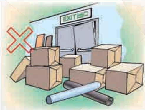
■ 防煙門絕對不能阻塞、損壞、拆除或將門打開楔住，並須配合妥善維修保養。
