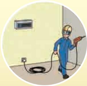
■ 漏電斷路裝置可防止使用電動工具時觸電的危險。
