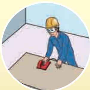
■ 工作完成後，要把鋸刀移除前，必須確認鋸刀完全停止。
