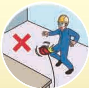
■ 放在工作台上電鋸因未完全停頓導致跳動，傷及工人腿部。
