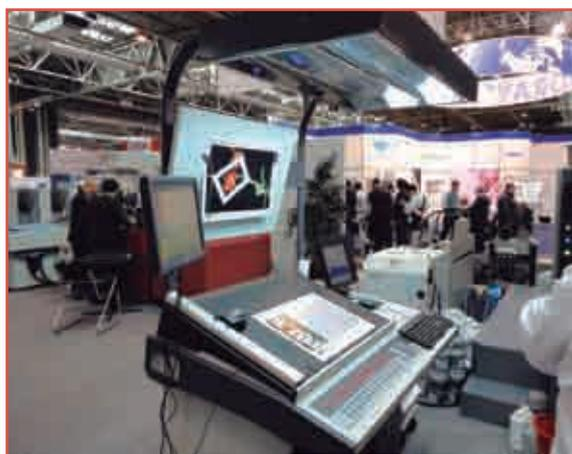
案，實現無縫操作。在 EasyTrax 控制台放上一個測試印張，用家只須按下測量按鈕讀取色控條，即可完成相關操作。EasyTrax 會將數據發送予 KICS 墨控系統，以便印刷機對墨鍵作出相應調整。■ 資料來源：愛色麗
