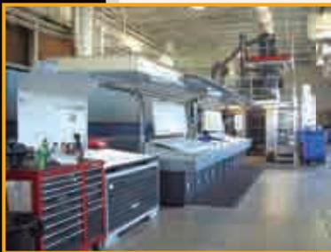
▲ Printing Industry Centre 設備完善，包括 Goss 滾筒印刷機、Heidelberg Speedmaster 平張印刷機、多部數碼印刷機，以及 CTP 系統等。
