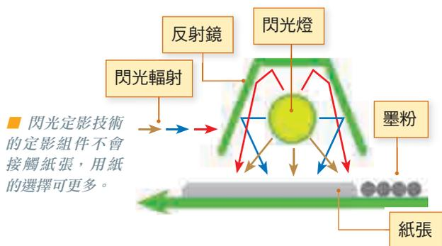
非接觸式閃光定影技術配合精細微粒墨粉，令墨粉分佈更加平均，即使是邊緣位置的落墨處也更加結實而清晰，整體輸出效果銳利奪目。
