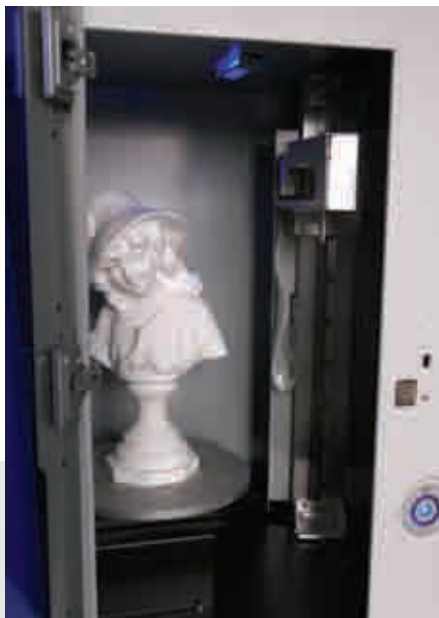
■ 3D 製模設備，能把模型的造型轉化為數據儲存。
