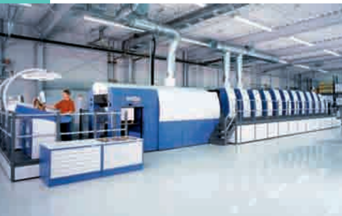
■ 2007 年面世的 DriveTronic SPC 專用版滾筒驅動裝置極大地縮短了高寶利必達 105 印刷機的活件更換時間。
