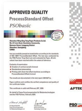
此次認證其中一個難處是對印刷機各方面穩定性及所用物料的要求，均需符合選定的印刷目標，另外最具挑戰性的是網點階調的控制，亦是永經堂認為最難的一個地方，包括補償曲線的計算及應用、油墨的乾濕掌握、印刷機由淺至深網點還原的穩定控制及印刷的均勻性控制等等，而最後印張內的網點值必須在 PSO 指定的寬容度範圍內才合格。
