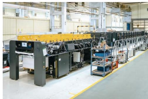
■ 高寶總裝車間正在裝配 17 個印刷和精整飾單元的超長包裝印刷機。
