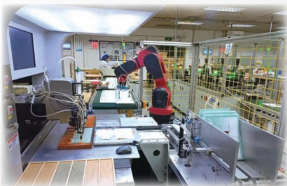
■ 印刷業可在後工序部門使用機械臂代替人手，自動執行重複的任務，減少人為錯誤。(圖片來源：「江蘇印刷」微信官方帳號)
