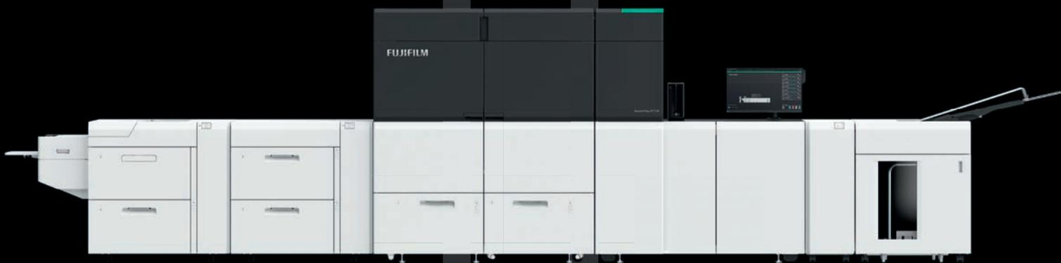
利用新的操作程式，配合人工智能和自動化技術，系統備有氣動式送紙器及靜電消除設計，高速送紙更穩定，同時可配合各類型紙張使用，例如極易黏附的塗布紙或膠片。系統亦備有六色印刷功能，在傳統四色碳粉以外，提供金、銀、透明、白和靄紅色選擇。送紙器亦能處理不同厚薄的紙張，紙張重量由 52gsm 至 400gsm。至於打印伺服器 Revoria™ Flow PC11 能以 1,200 x 1,200 dpi 及每種色 10-bit (1,024 漸層) 作高速 RIP 處理，產生高質素的圖像資料。
