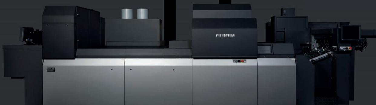
採用 SAMBA 工業級噴頭每秒可以噴出多達 90 億滴墨滴，最小墨滴大小只有 2 皮升，快速凝結塗布技術，使墨滴落下來就會被牢牢固化，每一顆網點邊緣平滑銳利，即使極小文字、極細線和纖毫畢現的膚質圖像都能完美呈現，能夠實現真正物理上的 1200dpi×1200 dpi 解像度，完美解決數字印刷防偽問題。
