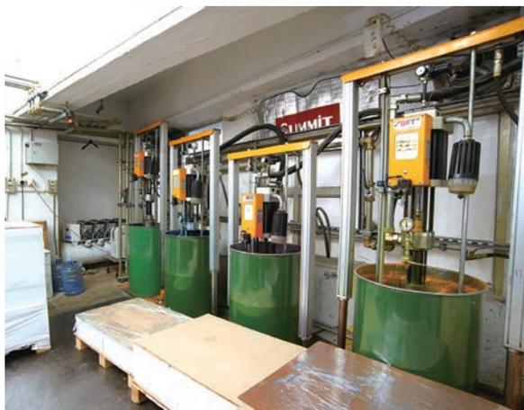
■ 環球印館在觀塘工業中心不同樓層有多個工廠單位，其自動供墨系統可同時為分處兩層的印刷機供墨。
