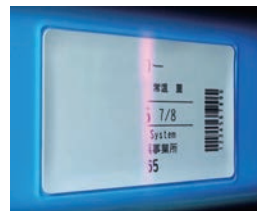
■ 理光在中國推出的可擦寫激光打印設備 LDTR (左圖),在不需人手操作的情況下,打印內容可重複印字消字達千次(右圖)。
