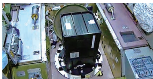
意大利 3D 打印的紫外線望遠鏡面向國際太空站的俄羅斯 Zvezda 模塊地球側窗口。
