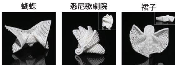
■ 採用「陶瓷墨水」以3D打印出來的陶瓷前驅體，可用於製造複雜的形狀。
