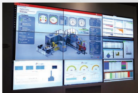
■ 「電腦化營運監控中心」透過在不同範疇應用的智能系統，模擬智能工廠的數碼化運作模式，並進行實時數據分析。
