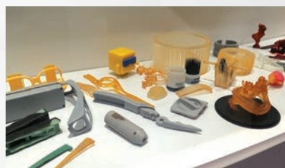
■ 同場參觀「3D 打印體驗廊」，了解不同的3D 打印技術，圖中是利用感光樹脂成型技術（SLA）而製成的模型。
