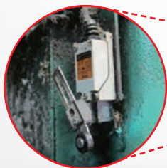
■ 裝置於壓紙機的互鎖式護罩裝置，以防危險部分於機門未關上時移動。
