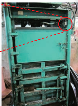
■ 裝置於壓紙機的互鎖式護罩裝置，以防危險部分於機門未關上時移動。
