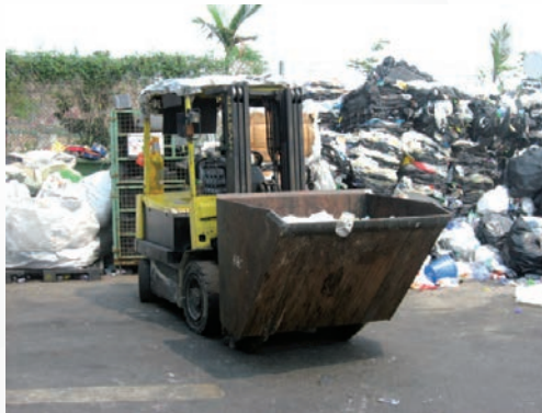
■ 使用合適剷車附件剷運物料，例如以物料斗剷運散料。
