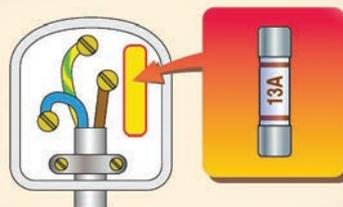
■ 保險絲必須要安裝在帶電線（火線）上。如需更換保險絲，必須更換同一電流熔解值的保險絲。
