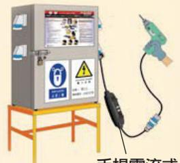
手提電流式漏電斷路器
