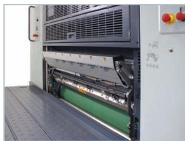
■ ROLAND 700 膠印機的 InlineColorPilot 聯線自動供墨導控系統和 SPL 同步換版系統，能夠有效提高愛沙尼亞書刊印刷公司 Tallinna 的生產力和產品品質。
