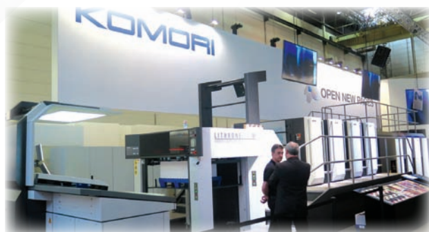
■ 小森的多款膠印機都進行了現場演示，包括擁有更短作業準備時間和高生產速度的 Lithrone GX40RP 印刷機。
