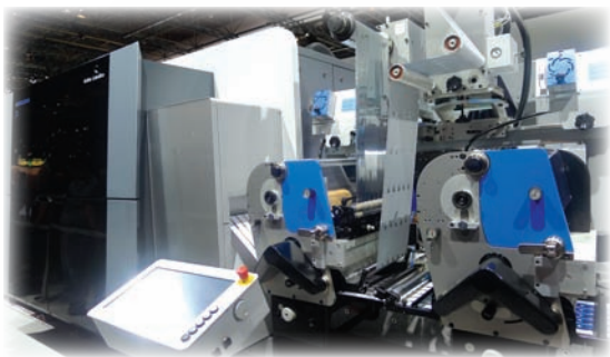
■ 海德堡在 drupa 2016，演示了以“Fire”為名的整個數碼印刷產品線，包括與富士膠片共同開發的 B1 幅面噴墨印刷機海德堡 Primefire 106（左圖），以及面向高增長數碼標籤印刷市場的捷拉斯 Labelfire 340（右圖）。
