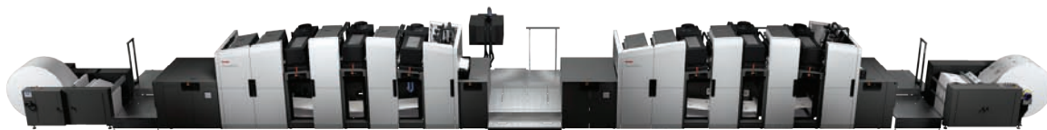
■ 柯達全新的數碼印刷中心配備了兩台柯達 Prosper 6000P 印刷機，每天可印刷 35,000 多份報紙。
