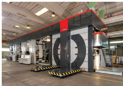
■ EVO XG 印刷機包含一個 10 色組衛星式印刷單元，以及兩個配備多區段乾燥裝置的連線柔版上光單元。
