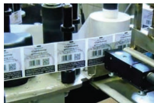
■ alphaJET into 直接安裝在貼標籤機內。
